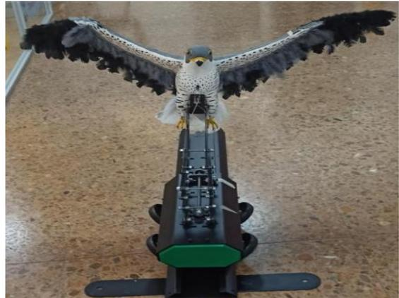
Imagen 9. Prototipo terminado sistema de peligro aviar
