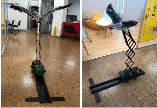
Imagen 8. Prototipo terminado sistema de peligro aviar
